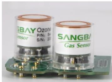
Fig. 24. Módulo Ozone sensor K-5S-O3-20
