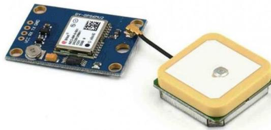
Fig. 17. NEO-6M GPS module with antenna.
