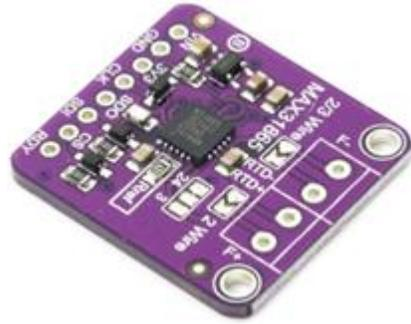
Fig. 13. MAX31865 transmitter module.
