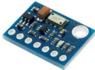
Fig. 14. MS5611 Pressure Sensor.
