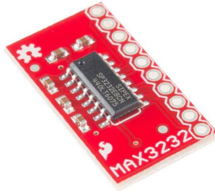
Fig. 22. SparkFun Transceiver Breakout RS232.
