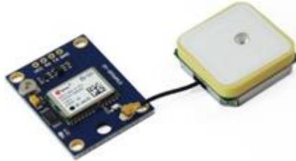
Fig. 15. NEO-6M GPS Module.
